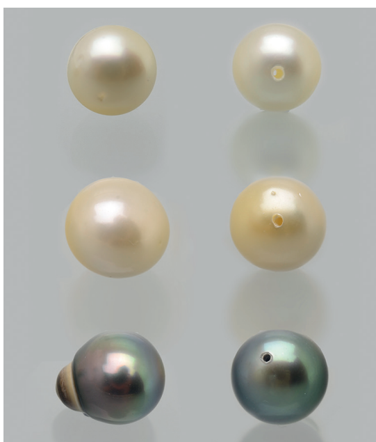
Drei Zuchtperlen von Pinctada radiata , maxima und margaritifera (von oben) vor und nach der Entnahme von Probenmaterial aus dem Bohrloch. / Trois perles de culture de Pinctada radiata , maxima et margaritifera (de haut en bas) avant et après prélèvement de l'échantillonnage par perçage.
